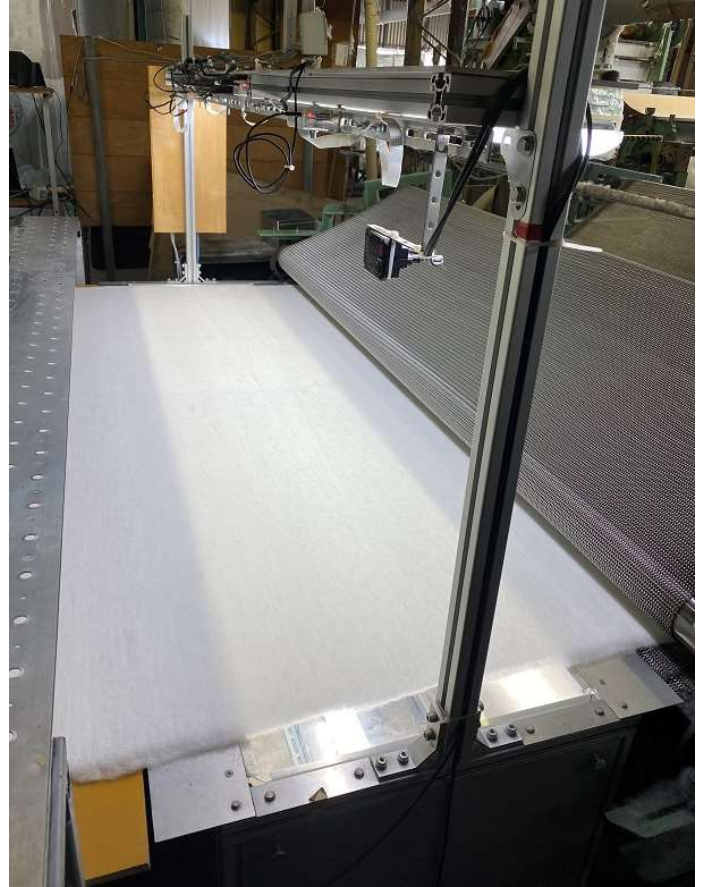
異物検知器付き製造ライン
